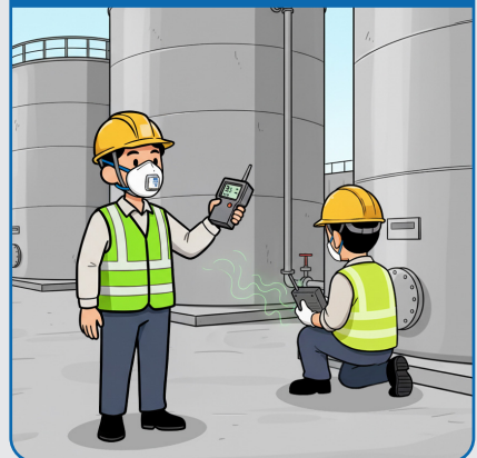
가스농도 측정 및 환기
